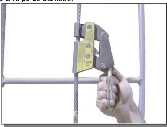
**Étape 5 :** Rattachez un mousqueton certifié par la CSA ou ANSI (selon l'autorité législative) au glisseur. La distance de l'anneau en « D » sternal au glisseur ne devrait pas excéder 0,15 m (6 pouces) en longueur. Avec le mousqueton installé, le glisseur ne peut pas être enlevé du câble. Pour s'assurer que le glisseur fonctionne adéquatement, tirez sur le mousqueton vers le bas pour reproduire une situation d'arrêt de chute. Le glisseur devrait agripper le câble de sécurité immédiatement.
